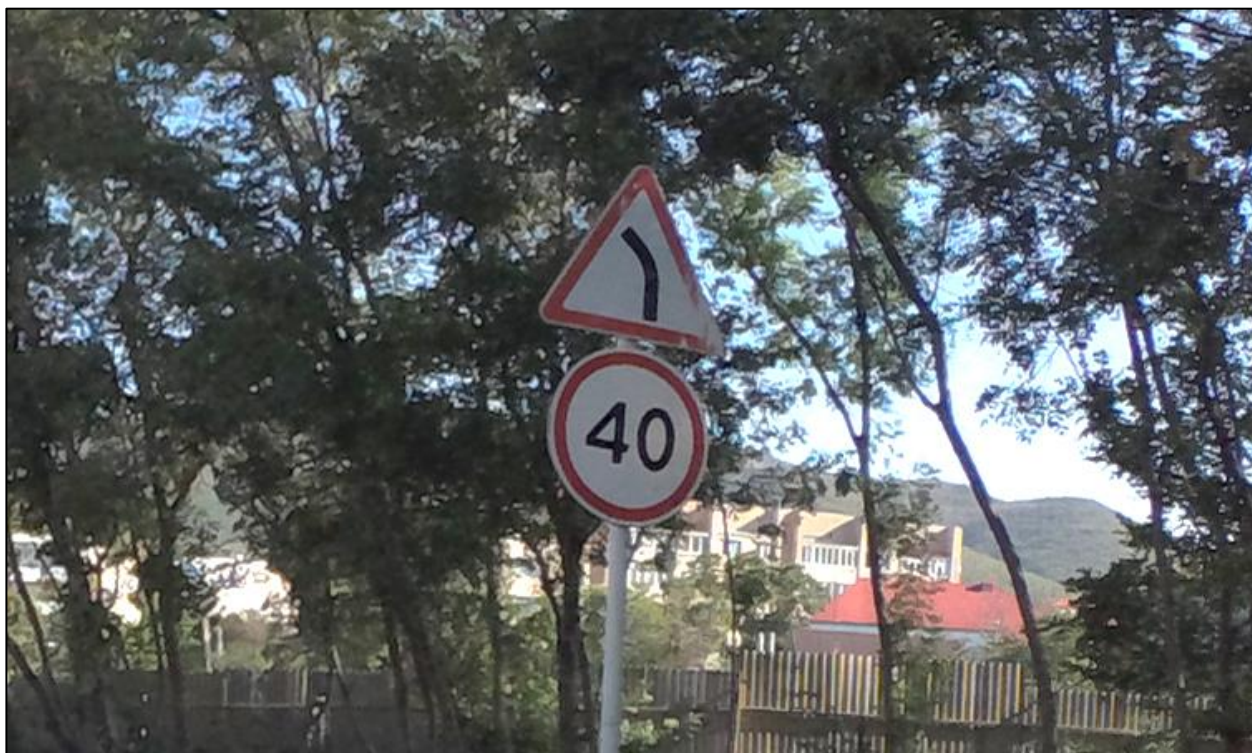
Рисунок 1.7.5 – Вид эксплуатационного состояния знака 1.11.1 «Опасный поворот» и знака 3.24 «Ограничение максимальной скорости», расположенных по ул. Кончаловского, г. Геленджик
