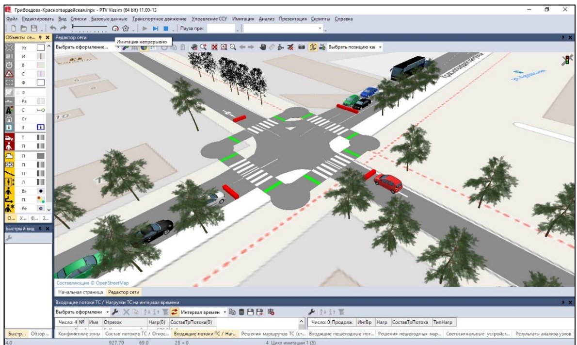
Рисунок 2.5.6 – 3D модель перекрёстка ул. Грибоедова - ул. Красногвардейская, г. Геленджик после установки светофорных объектов
